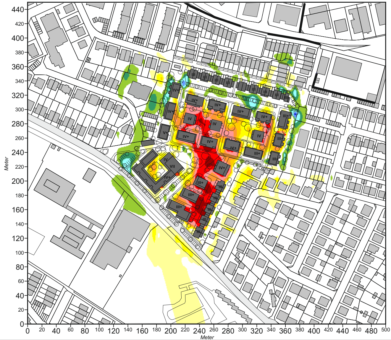
Abb. 23.3 Vorher-Nachher-Vergleich, Ergebnisse von Strömungssimulationen. Veränderung der Windgeschwindigkeit durch den Plan-Zustand 2 m ü.G. Windanströmung aus Norden mit 2.5 m/s in einer Höhe von 10 m ü.G.
