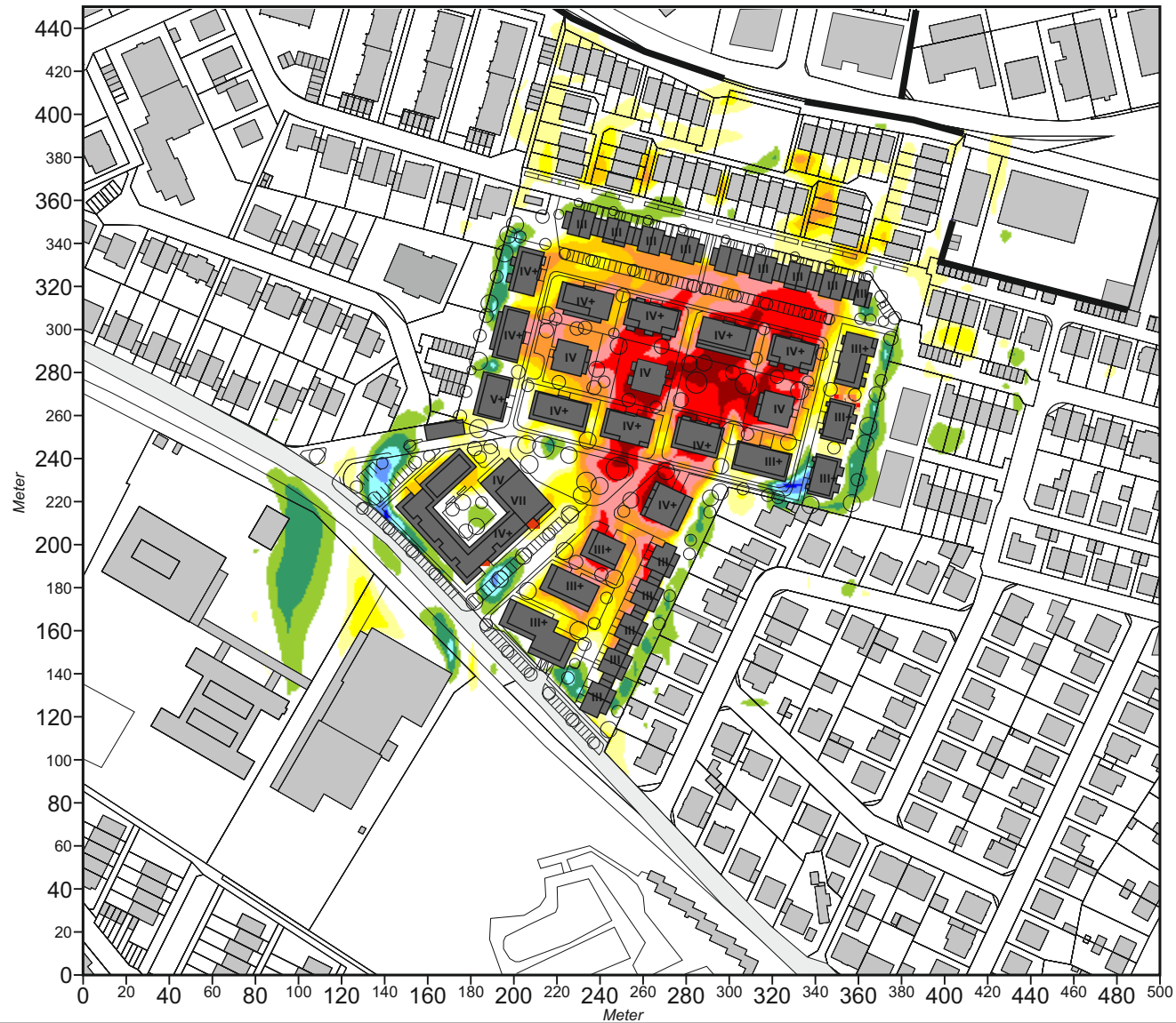
Abb. 21.3 Vorher-Nachher-Vergleich, Ergebnisse von Strömungssimulationen. Veränderung der Windgeschwindigkeit durch den Plan-Zustand 2 m ü.G. Windanströmung aus Süden mit 2.5 m/s in einer Höhe von 10 m ü.G.
