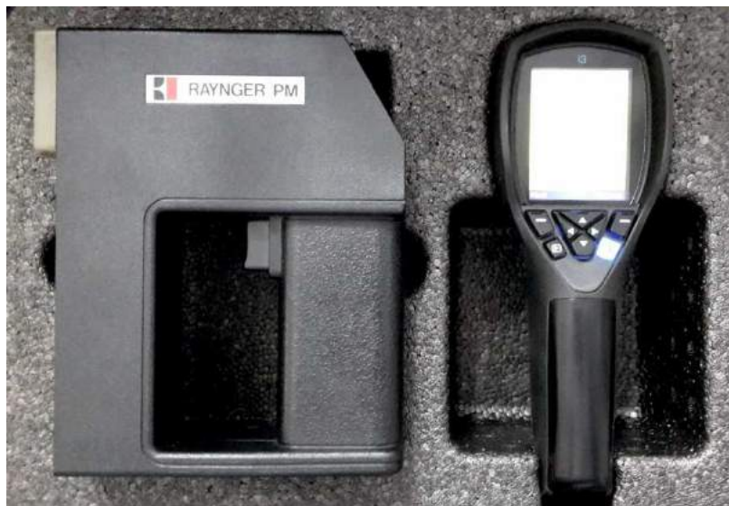
Foto 1: Fotografische Dokumentation – Messtechnik zur Erfassung der Oberflächenstrahlungstemperaturen (Foto: ÖKOPLANA)
