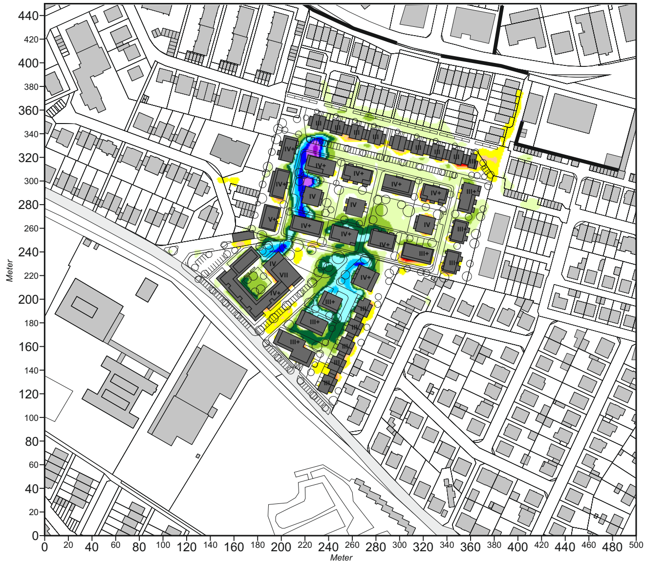
Abb. 25.3 Vorher-Nachher-Vergleich. Ergebnisse von Lufttemperatursimulationen. Veränderung der Lufttemperatur 2 m ü.G. durch den Plan-Zustand. Windanströmung aus Südwesten mit 2.5 m/s in einer Höhe von 10 m ü.G. Heißer Sommertag (16:00 Uhr)
